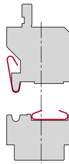
Инструмент для предварительной гибки и плющения с подпружиненной матрицей для производства скобы (категория 2)
