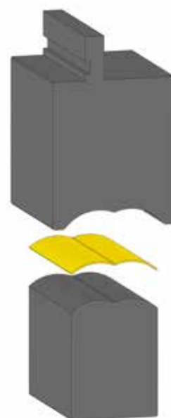
Двойной радиусный формовочный инструмент
