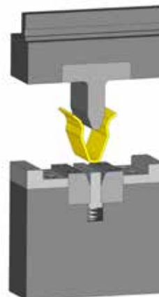
Станция 2: U-образный инструмент с подпружиненным выталкивателем
